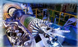
水素ガスタービン
